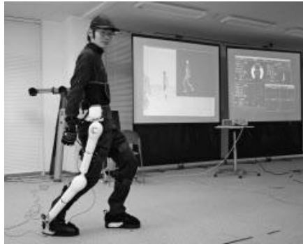
出所：筑波大学山海研究室 ロボットスーツHAL（左）と体の動きなどの表示（奥）
